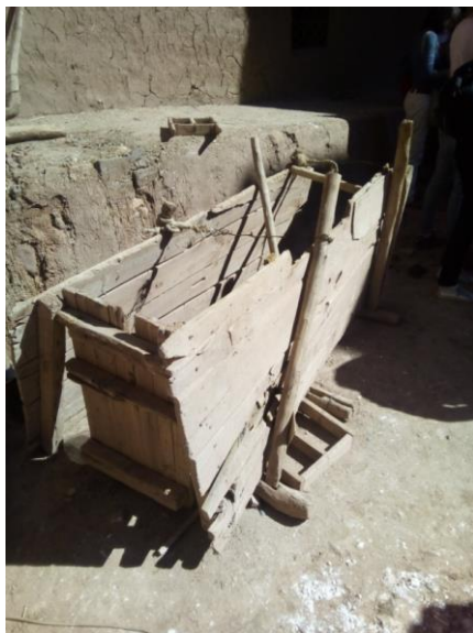
Obr. 4 a 5: Bednění a dusadlo pro výrobu dusaných hliněných stěn.
