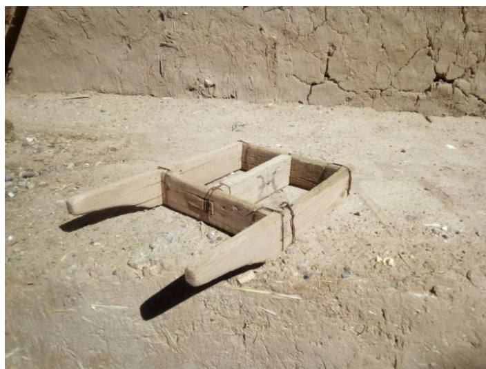
Obr. 6: Forma pro výrobu nepálených hliněných cihel
